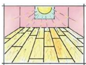
Asenna laudat päävalon suuntaisesti.
