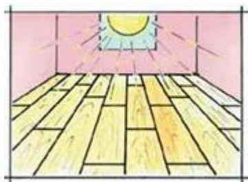
Asenna laudat päävalon suuntaisesti.
